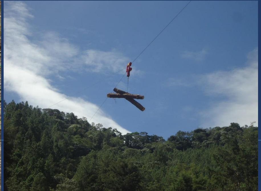
En el predio de La Macarena se venía trabajando con transporte mular el cual ocasionaba por la pendiente remoción del suelo ocasionando un poco de erosión; para esto la empresa ejecutó acciones de mejora a través de la instalación de un tracto Koller para reducir el impacto producido.
